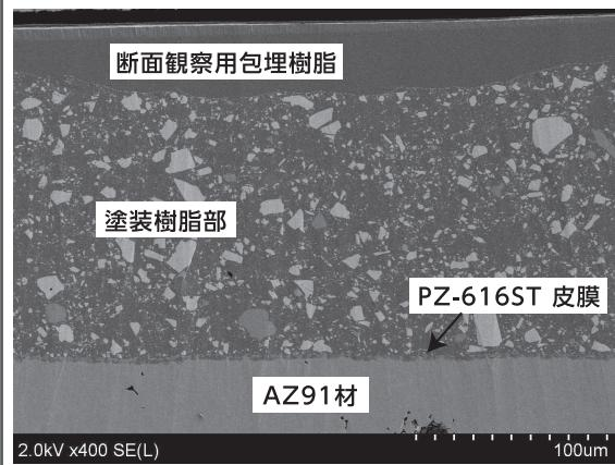
PZ-616ST皮膜は0.1μm以下の薄膜で、良好な塗装密着性が得られます。
