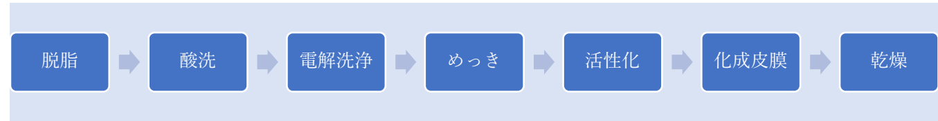
図2. 亜鉛－ニッケル合金めっきの処理工程（一般的な処理工程）
